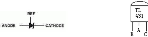
左图是该器件的符号。3 个引脚分别为：阴极 (CATHODE)、阳极 (ANODE) 和参考端 (REF)。TL431 的具体功能可以用如图 1 的功能模块示意。
